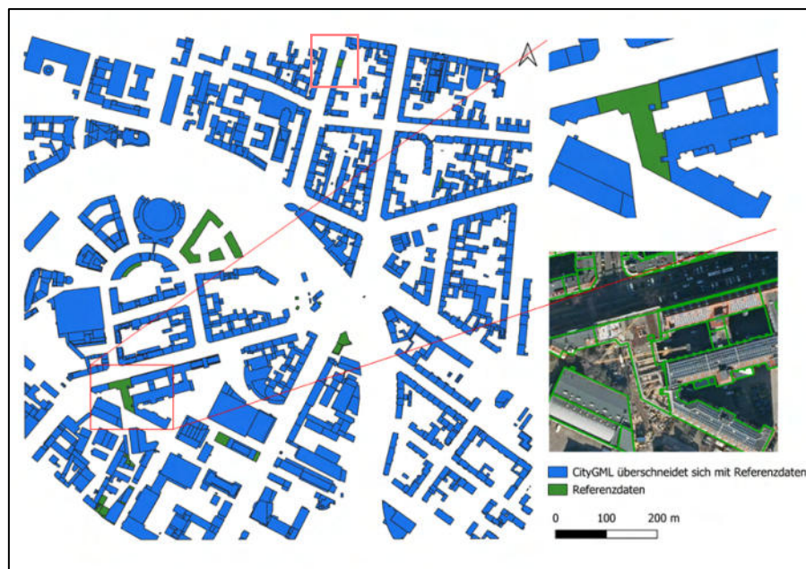
Abbildung 24: Fehlende Gebäudeumrisse im CityGML im Vergleich zu den Referenzdaten
